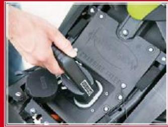
Las baterías se pueden recargar en 3,5 horas, o en 30 minutos al 80%.
