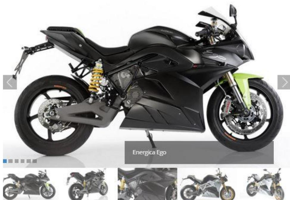
So sieht eines der modernsten und innovativsten Motorräder aus: Die Energica Ego, die erst seit kurzem bei den Händlern steht. Die Ego ist das erste elektrische Superbike „made in Italy“. Das grüne Herz der Energica Ego ist ein Permanentmagnet-Synchronmotor mit Öl Kühlung, der in der Lage ist, eine Leistung von 100 kW / 136 PS und ein Drehmoment von 195 Nm zu entwickeln.
